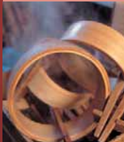
曲げたばかりのわっぱは器具で押さえれば早く乾燥させる
